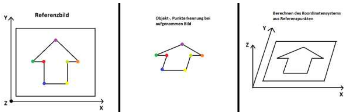
Abbildung 5 Positionserkennung mittels Marker
